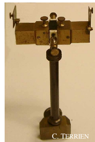
Figure 4. Pile de MELLONI.
